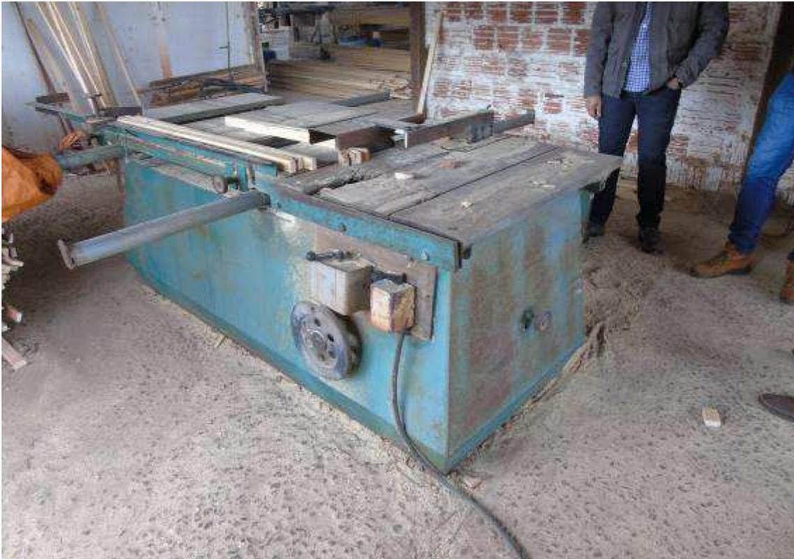
Figura 13 Dispositivo de acionamento de máquina inadequado
