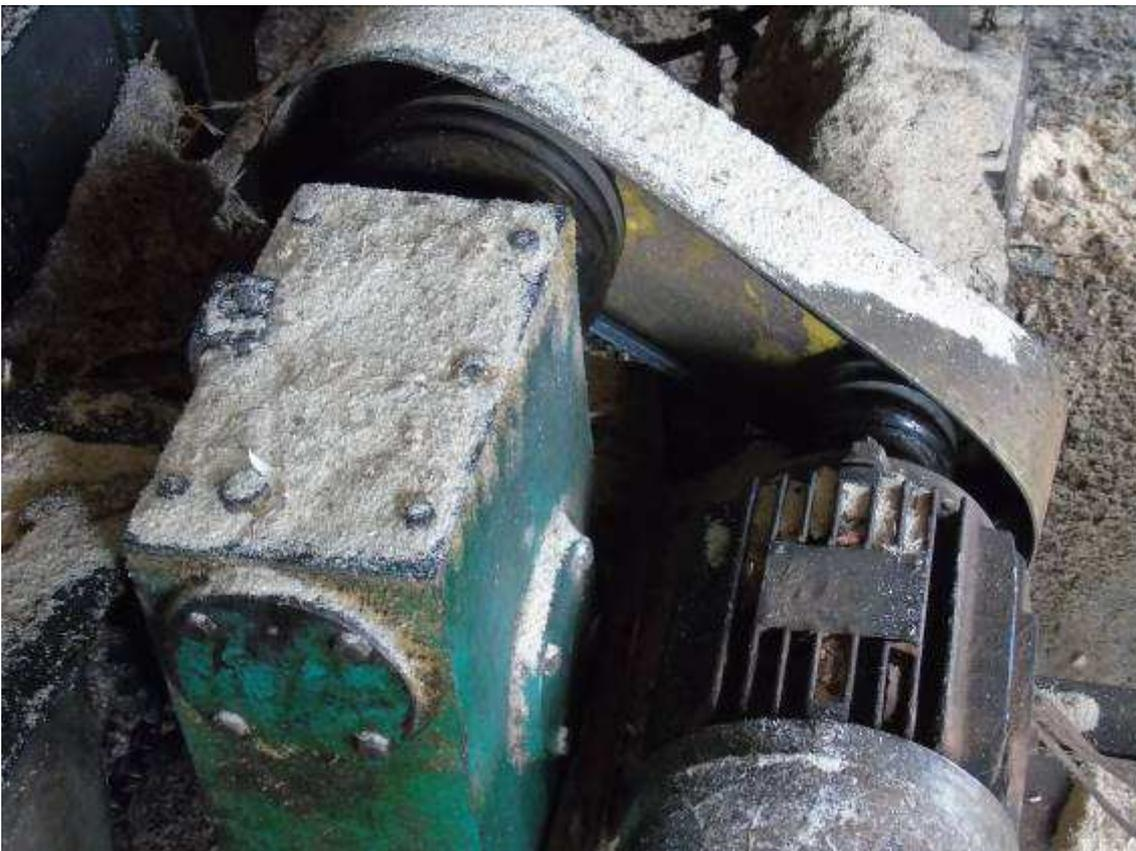
Figura 51: Zonas de perigo de máquina e equipamentos sem possuir sistemas de segurança, caracterizados por proteções fixas, proteções móveis e dispositivos de segurança interligados, que garantam proteção à saúde e à integridade física dos trabalhadores.
