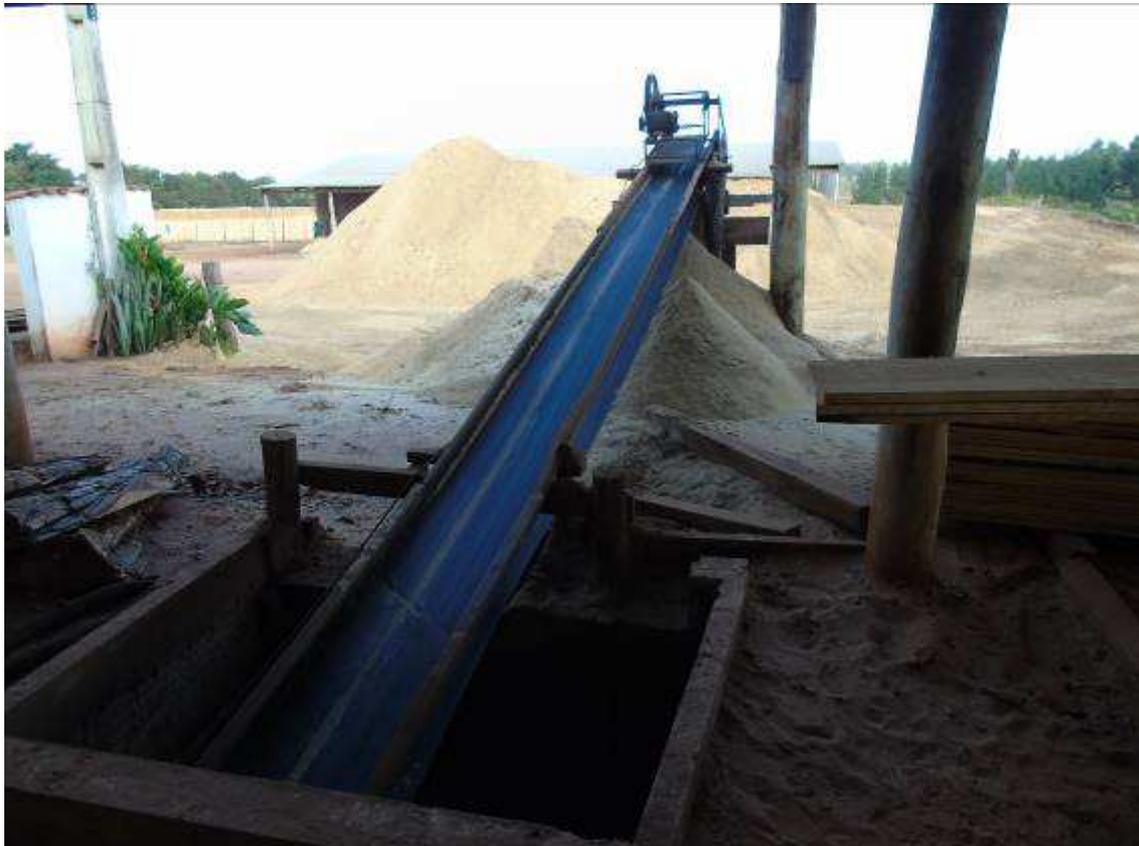
*Figura 26 Abertura em piso sem proteção contra quedas*
