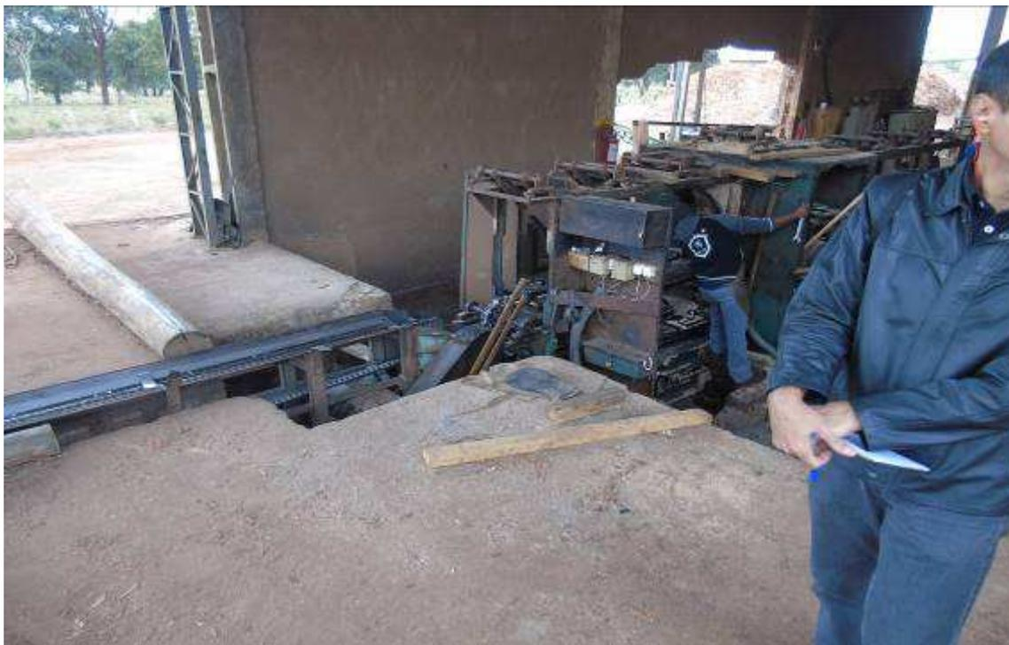
Figura 58: Meios de acesso com risco de quedas, sejam mantidos sem sistema de proteção (guarda corpos)
