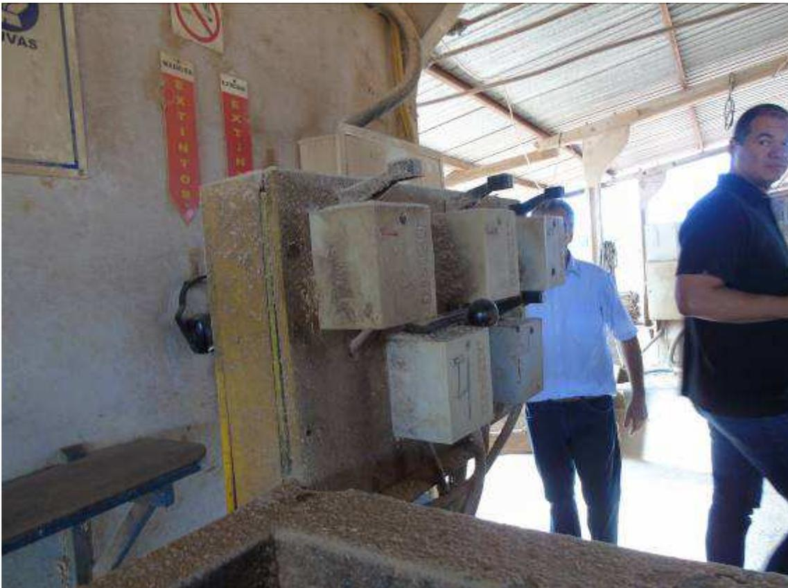
Figura 14 Dispositivo de acionamento de máquina inadequado
