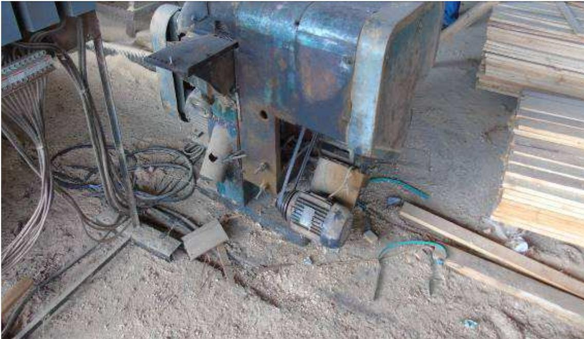
Figura 50: Zonas de perigo de máquina e equipamentos sem possuir sistemas de segurança, caracterizados por proteções fixas, proteções móveis e dispositivos de segurança interligados, que garantam proteção à saúde e à integridade física dos trabalhadores.
