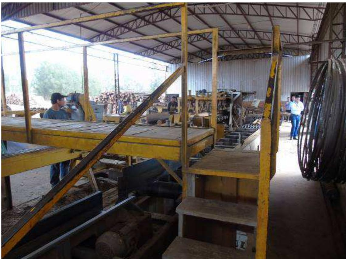
Figura 89: Meio de acesso com risco de quedas, sejam mantidos sem sistema de proteção (guarda corpos com, apenas, travessão superior)
