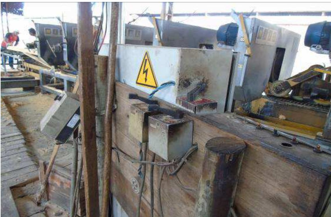
Figura 85: Equipamento sem dispositivos adequados de partida, acionamento e parada. (Chave tipo lombard)
