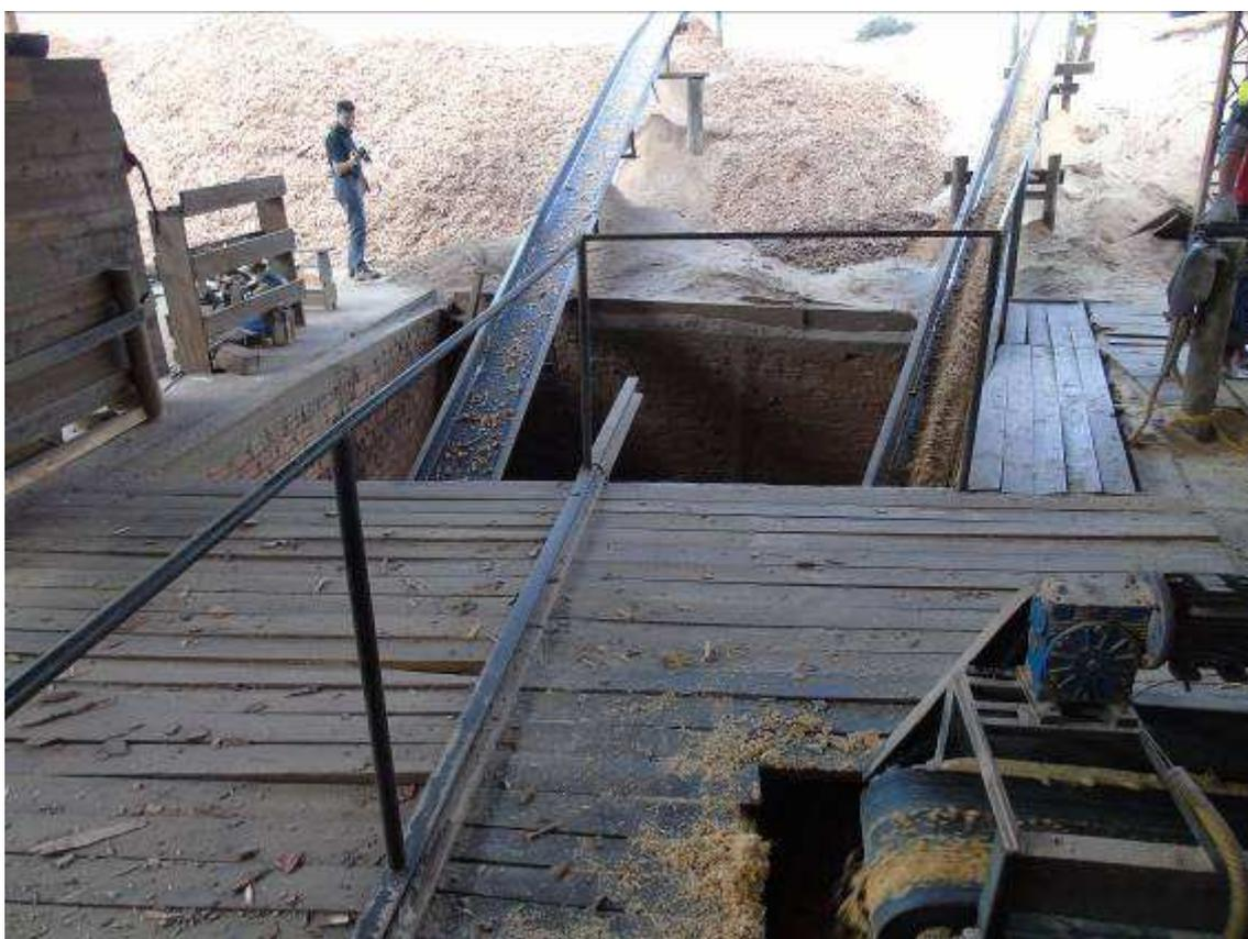
Figura 71: Local de trabalho, acima do solo, sem ser dotado de proteção contra quedas (guarda corpo de proteção).
