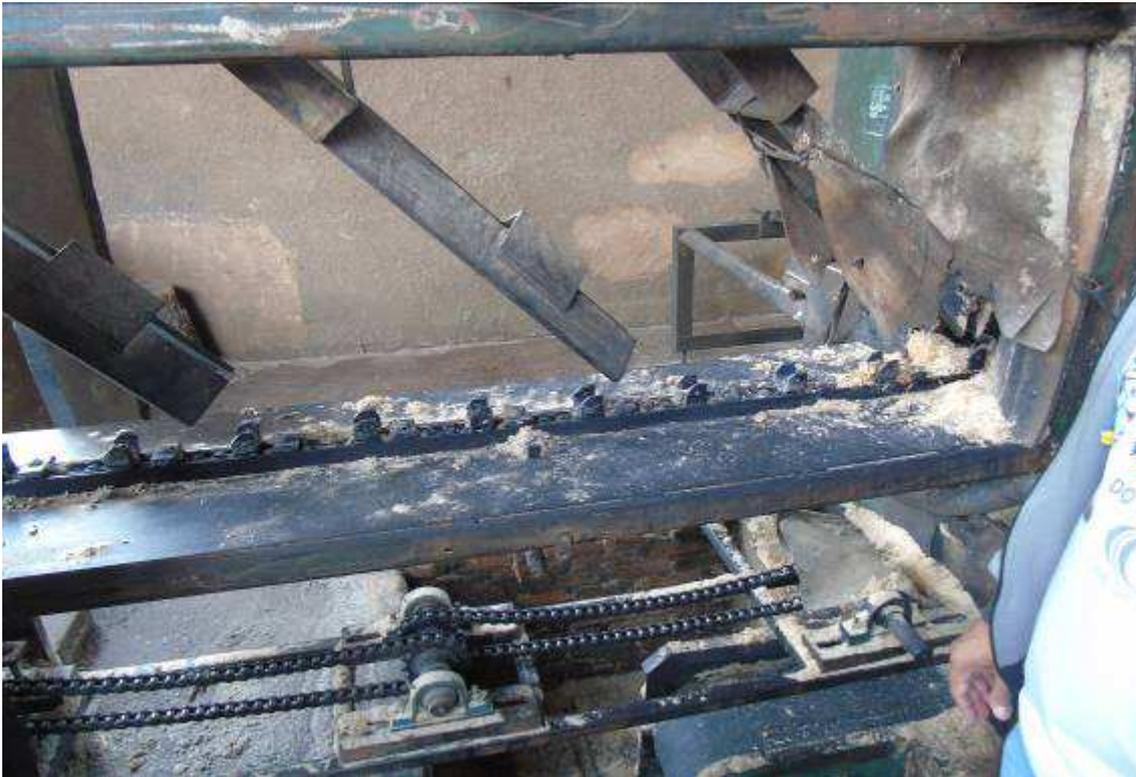
Figura 52: Zonas de perigo de máquina e equipamentos sem possuir sistemas de segurança, caracterizados por proteções fixas, proteções móveis e dispositivos de segurança interligados, que garantam proteção à saúde e à integridade física dos trabalhadores.
