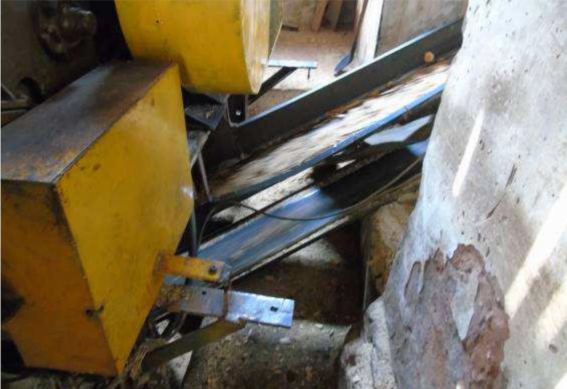
*Figura 17 Transportador contínuo de materiais sem proteção em todas as zonas de perigo*
