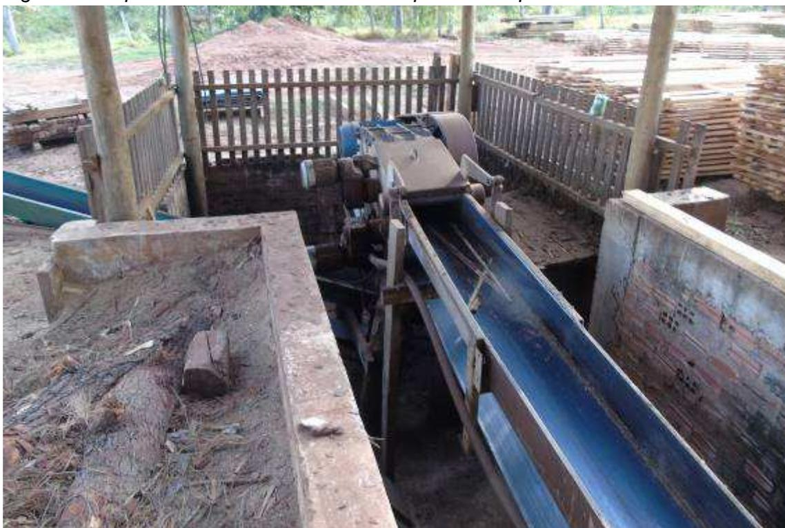
*Figura 38 Transportador contínuo de materiais sem proteção adequada*
