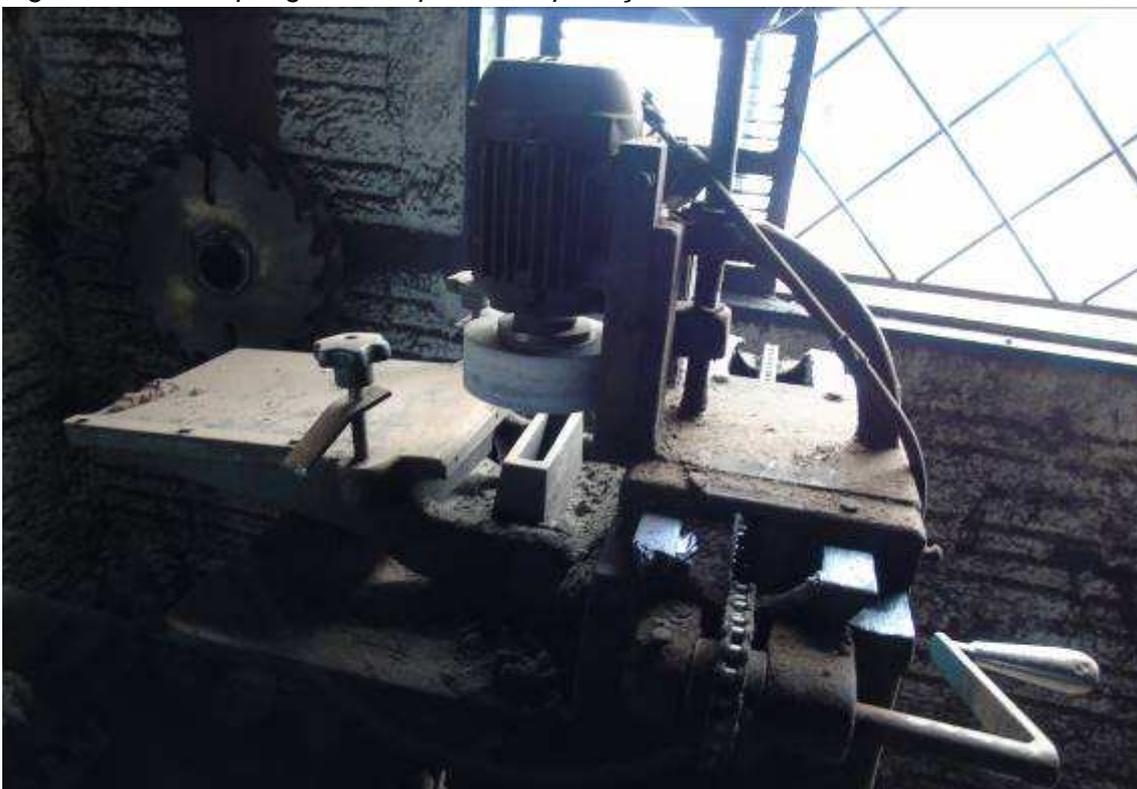
*Figura 10 Zona de perigo de máquina sem proteção*
