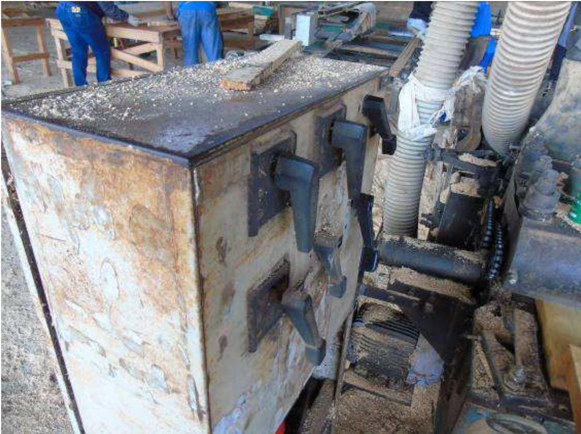
Figura 56: Equipamento sem dispositivos adequados de partida, acionamento e parada. (Chave tipo lombard)
