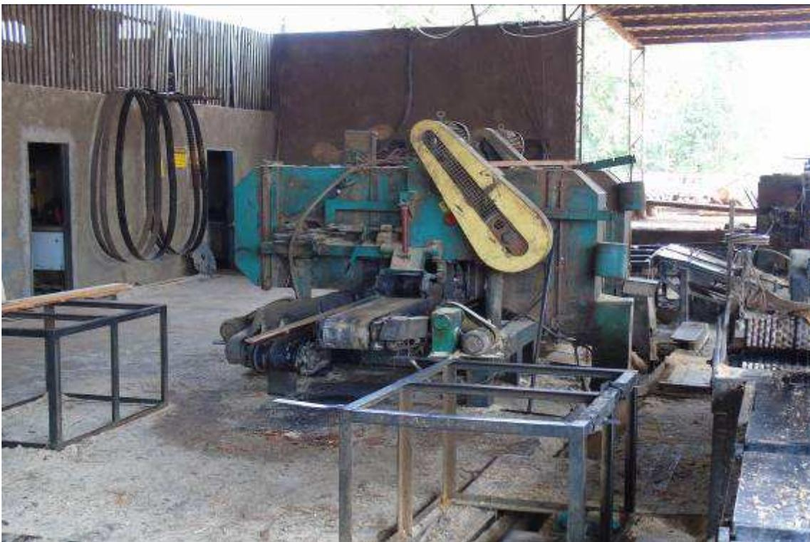
Figura 55: Equipamento sem dispositivos adequados de partida, acionamento e parada. (Chave tipo lombard)
