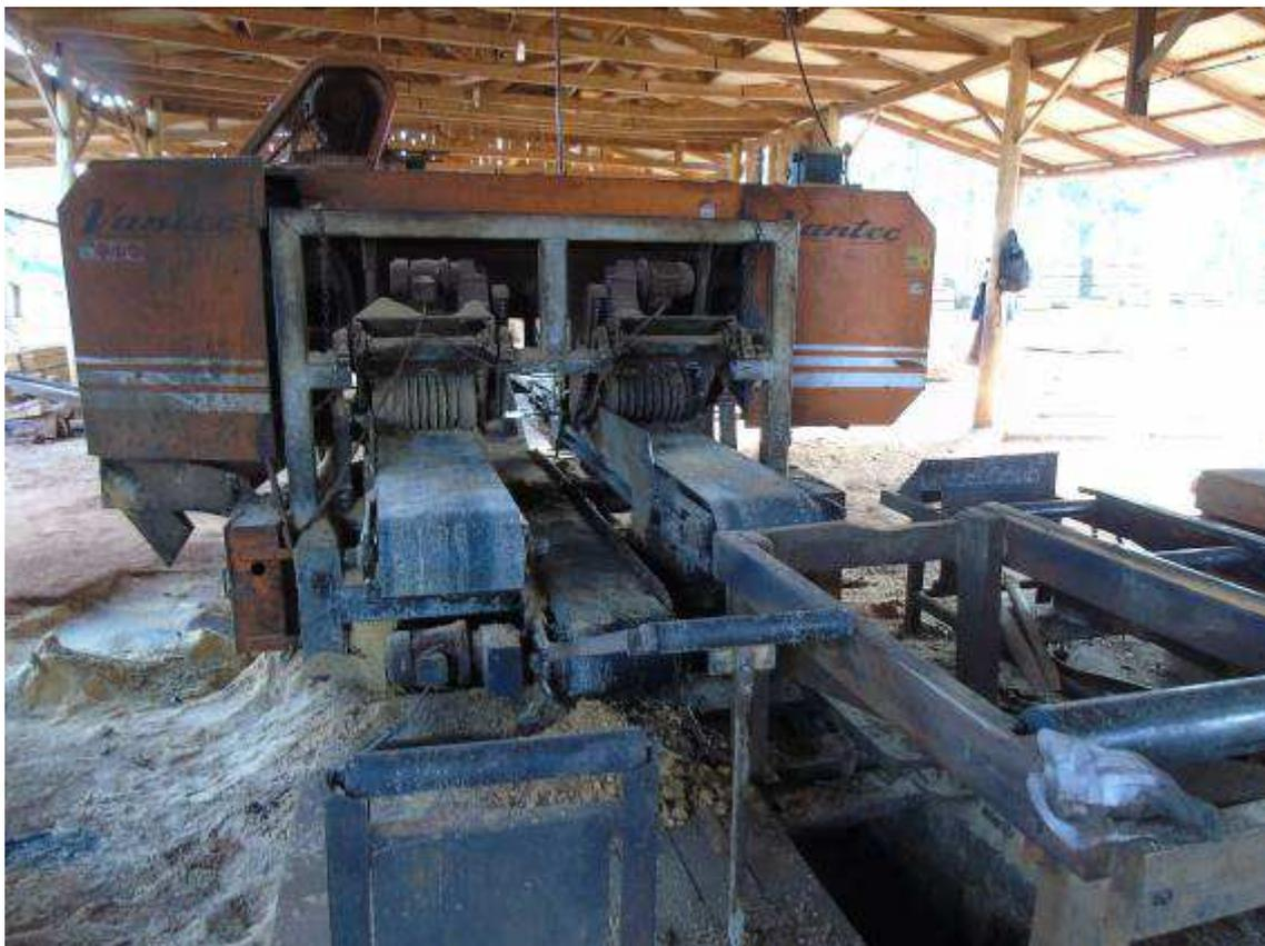
*Figura 31 Zona de perigo de máquina sem proteção*
