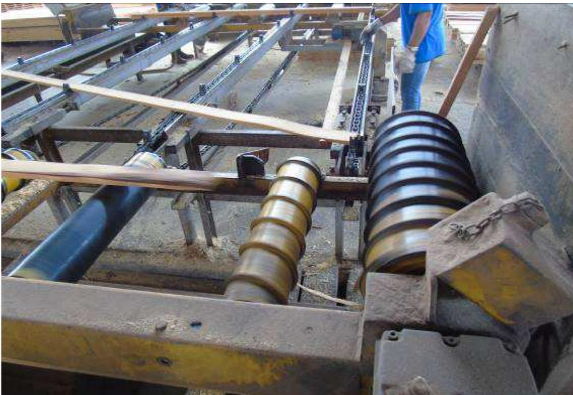
Figura 83: Zonas de perigo de máquina e equipamentos sem possuir sistemas de segurança, caracterizados por proteções fixas, proteções móveis e dispositivos de segurança interligados, que garantam proteção à saúde e à integridade física dos trabalhadores.
