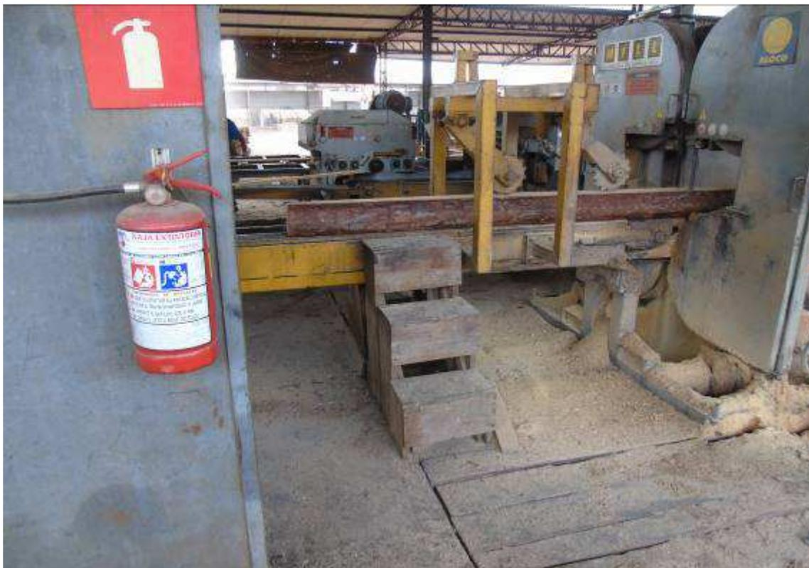
Figura 76: Escada sem corrimão, nos dois lados, além de quantidade de degraus inferior à necessária para atingir o piso ou patamar superior a ser acessado.
