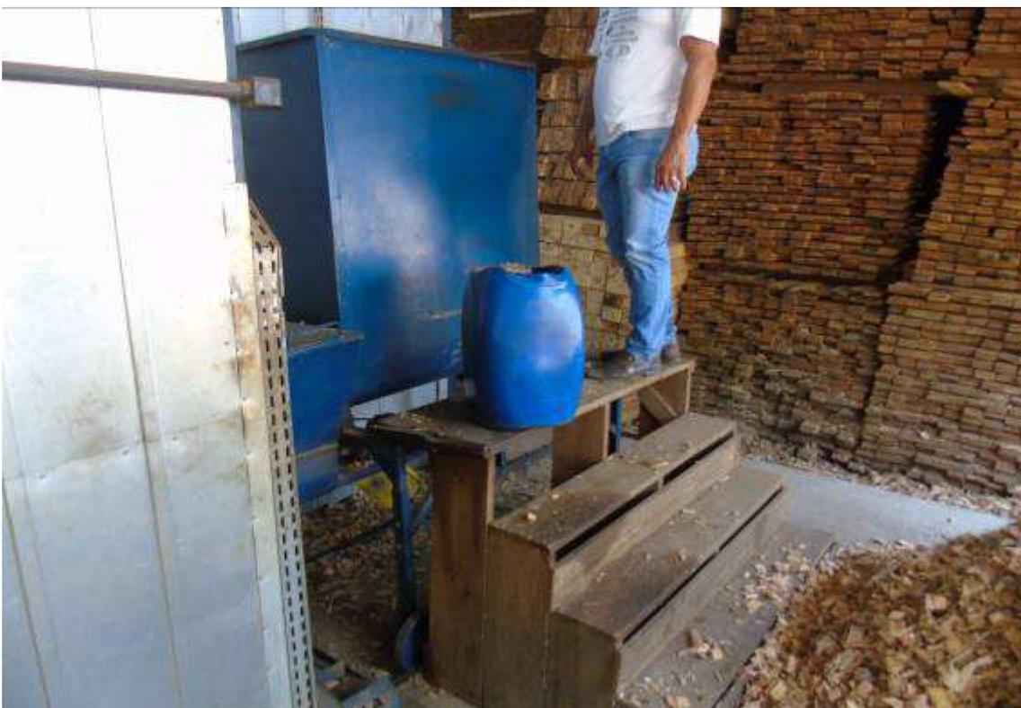
Figura 75: Escada sem corrimão, nos dois lados, além de quantidade de degraus inferior à necessária para atingir o piso ou patamar superior a ser acessado.
