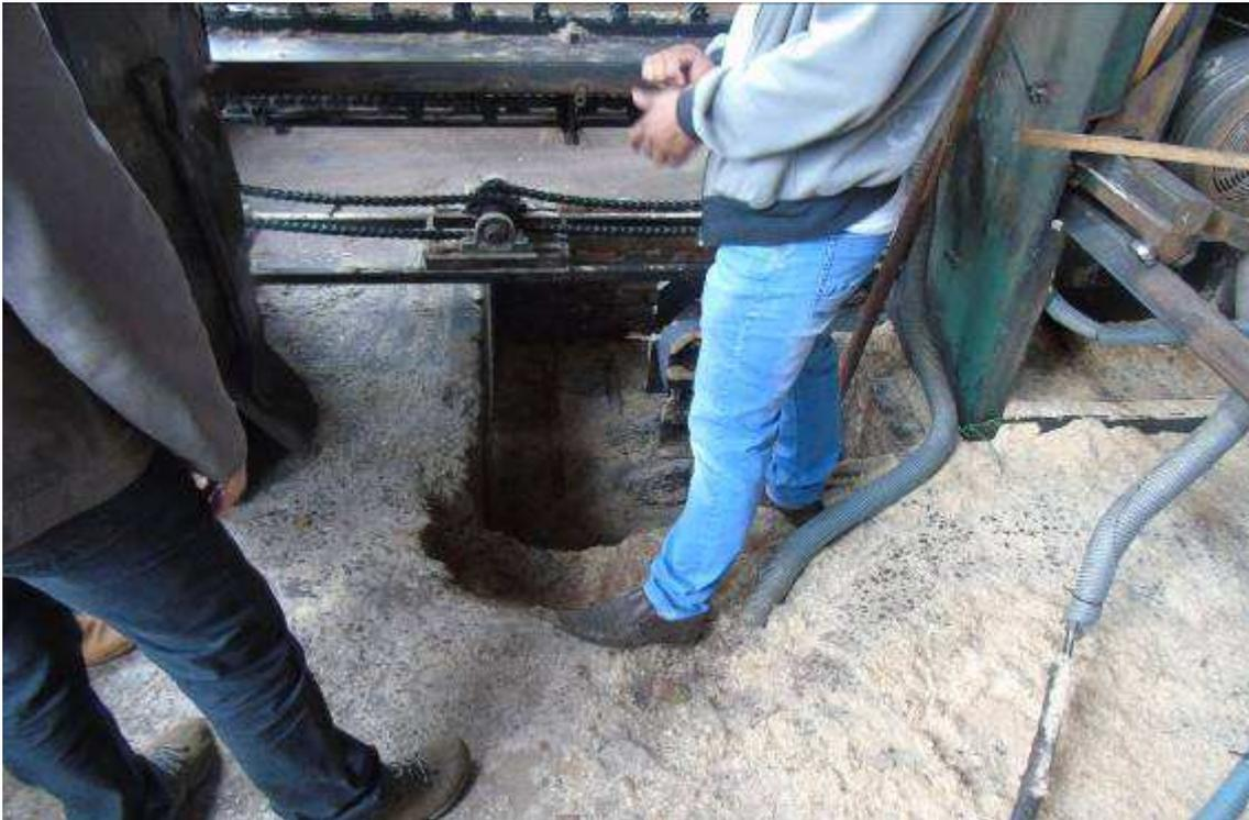
*Figura 42: Abertura no piso que possibilita a queda de pessoas ou objetos sem ser dotada de guarda corpo ou outro tipo de proteção contra quedas.*
