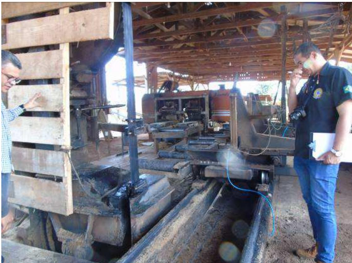
*Figura 33 Zona de perigo de máquina sem proteção*
