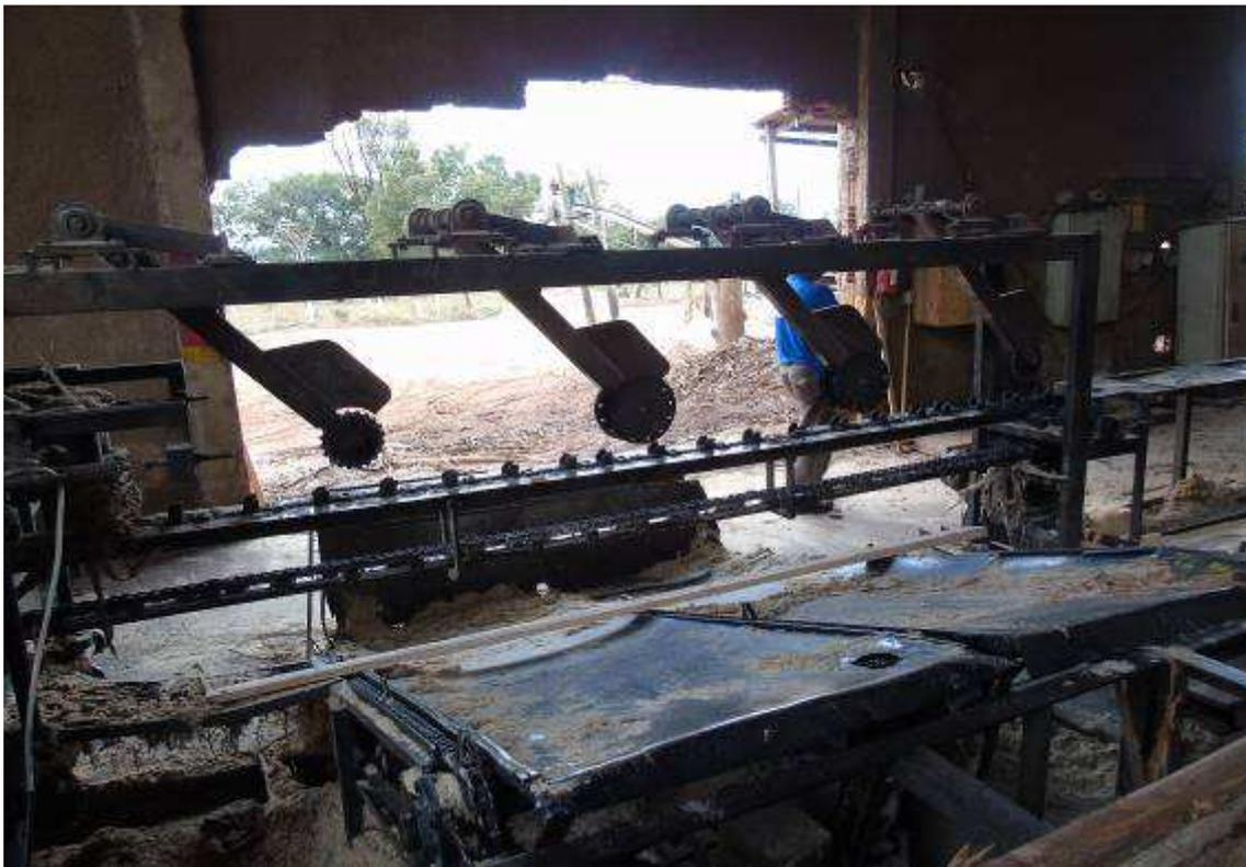
Figura 60: Transportador contínuo de materiais sem proteção dos pontos de esmagamento, agarramento e aprisionamento, como esteiras, roletes, rolo de cauda e outras partes móveis.
