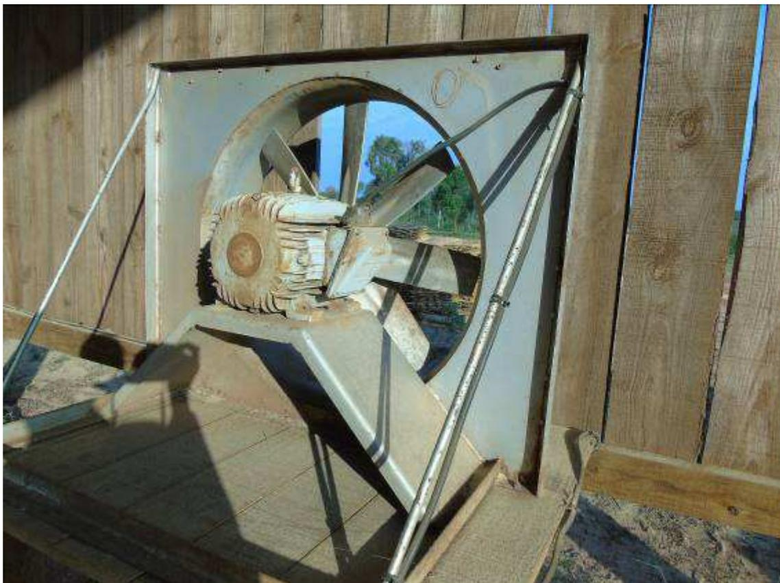
*Figura 35 Zona de perigo de máquina sem proteção*
