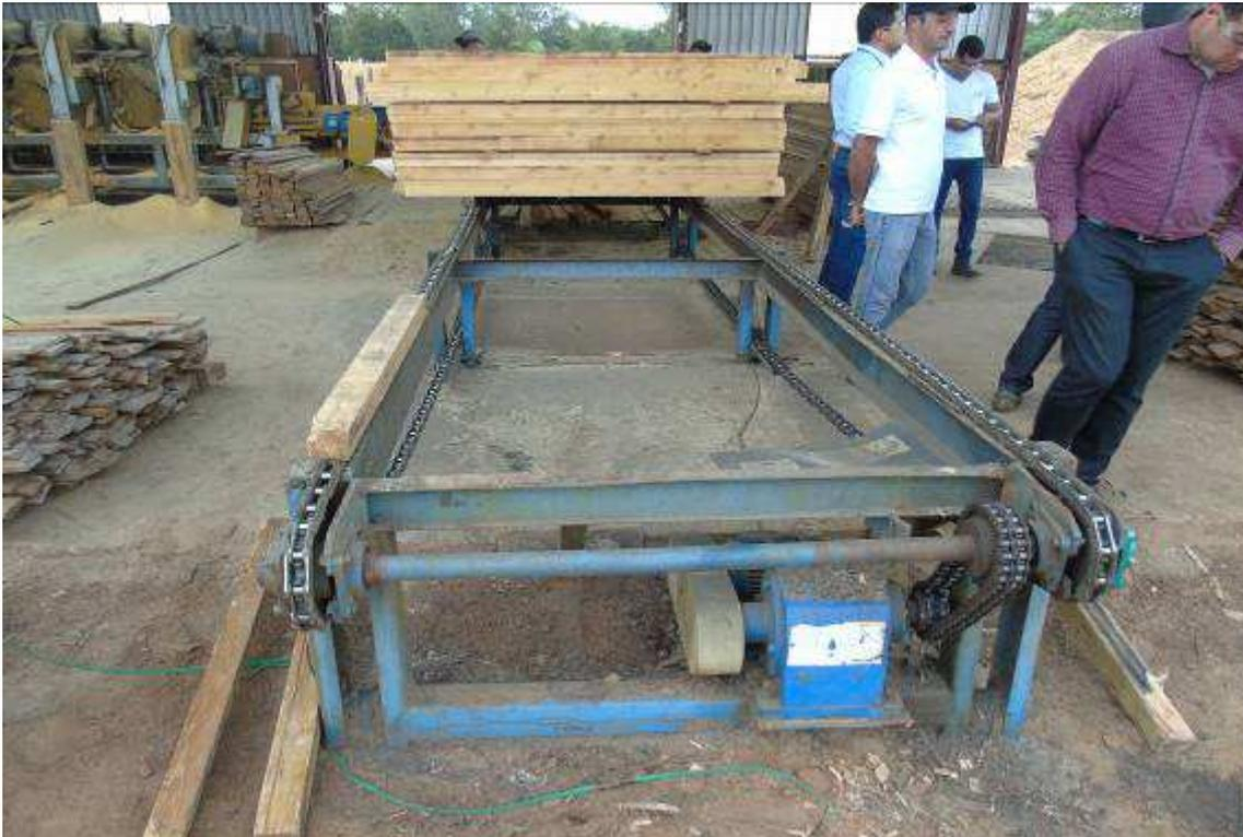
Figura 82: Zonas de perigo de máquina e equipamentos sem possuir sistemas de segurança, caracterizados por proteções fixas, proteções móveis e dispositivos de segurança interligados, que garantam proteção à saúde e à integridade física dos trabalhadores.
