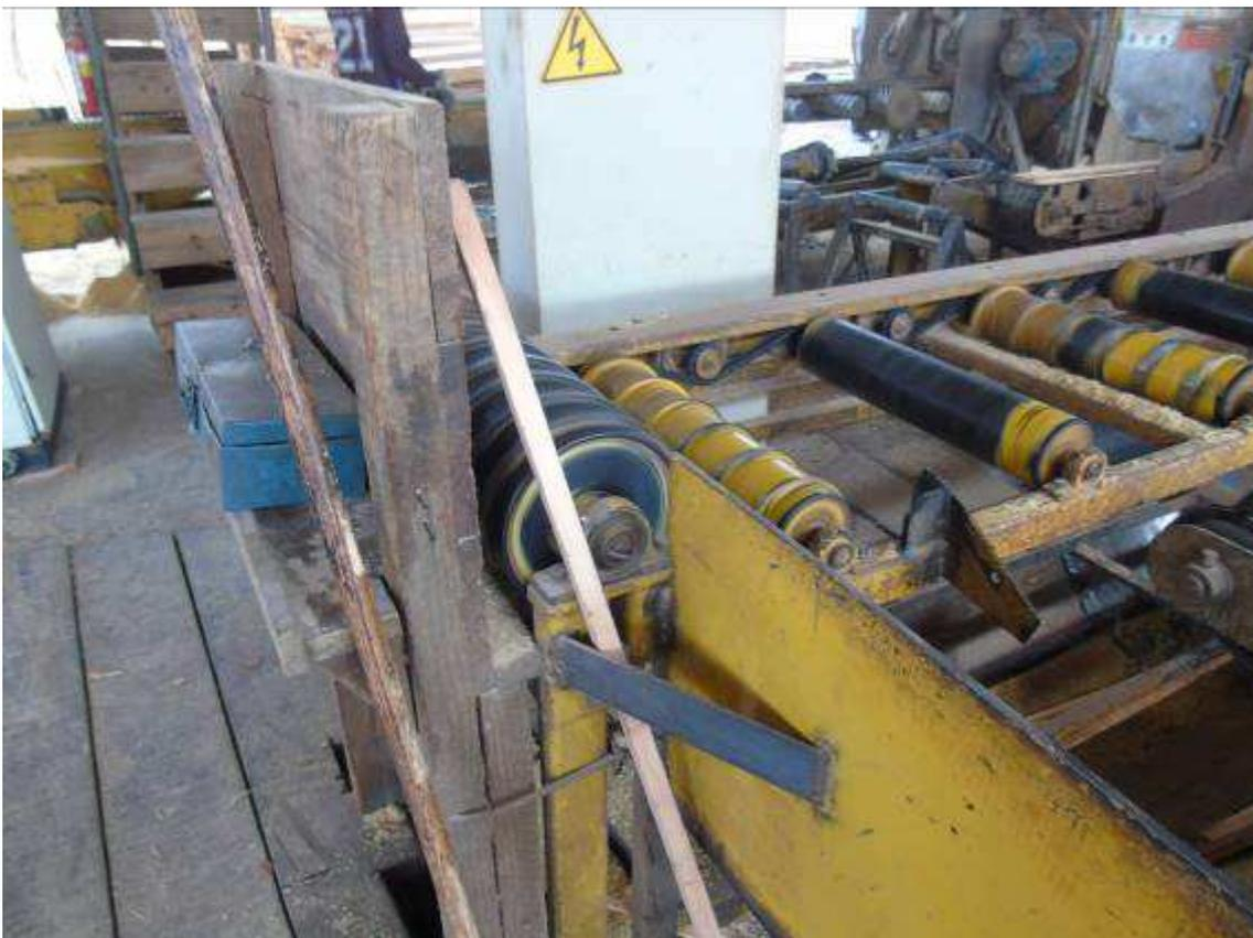
Figura 84: Zonas de perigo de máquina e equipamentos sem possuir sistemas de segurança, caracterizados por proteções fixas, proteções móveis e dispositivos de segurança interligados, que garantam proteção à saúde e à integridade física dos trabalhadores.
