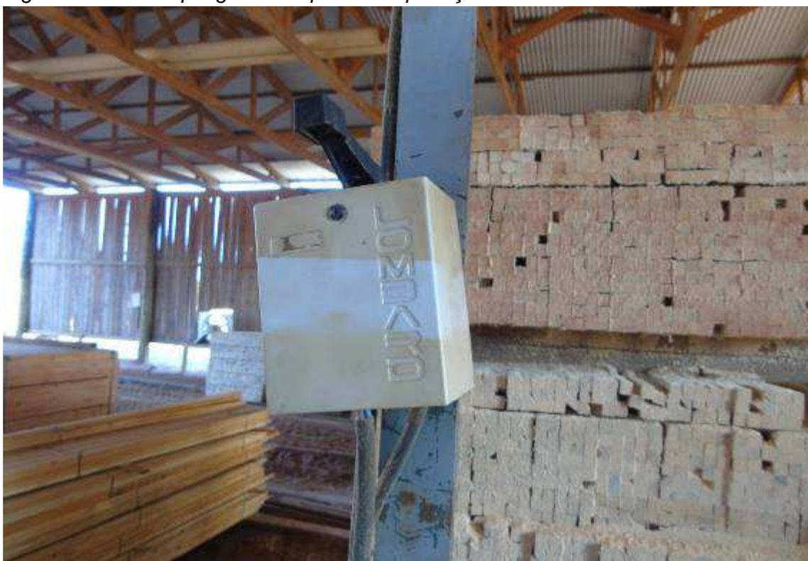
*Figura 36 Dispositivo de acionamento de máquina inadequado*
