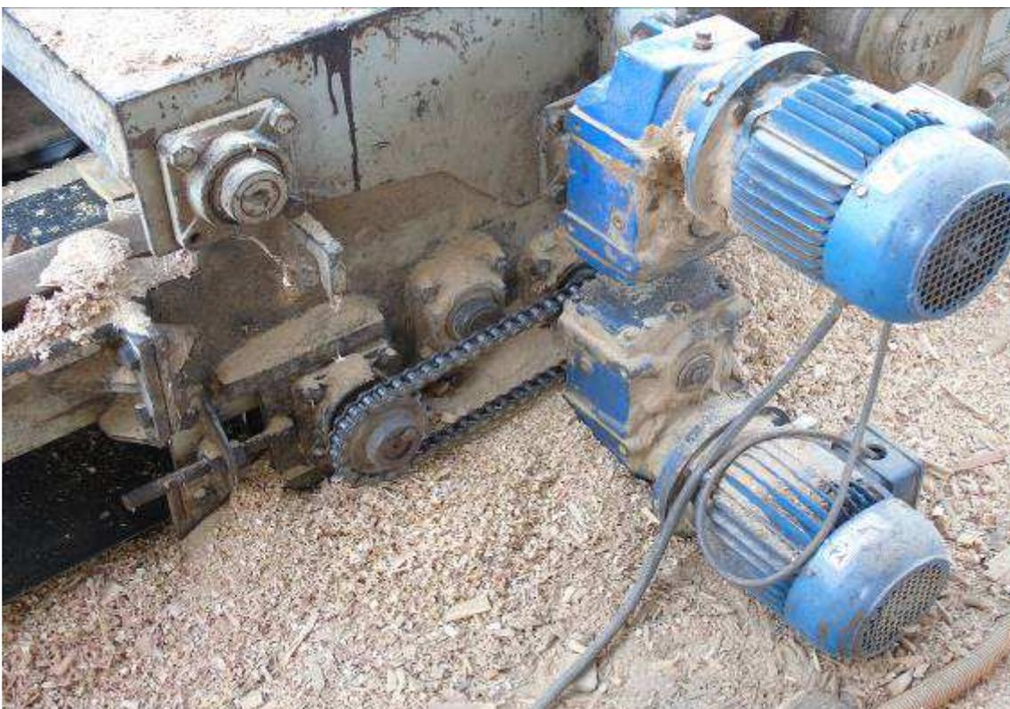
Figura 81: Zonas de perigo de máquina e equipamentos sem possuir sistemas de segurança, caracterizados por proteções fixas, proteções móveis e dispositivos de segurança interligados, que garantam proteção à saúde e à integridade física dos trabalhadores.
