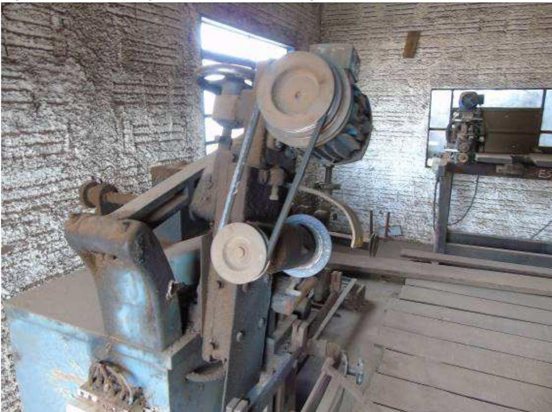
*Figura 12 Zona de perigo de máquina sem proteção*
