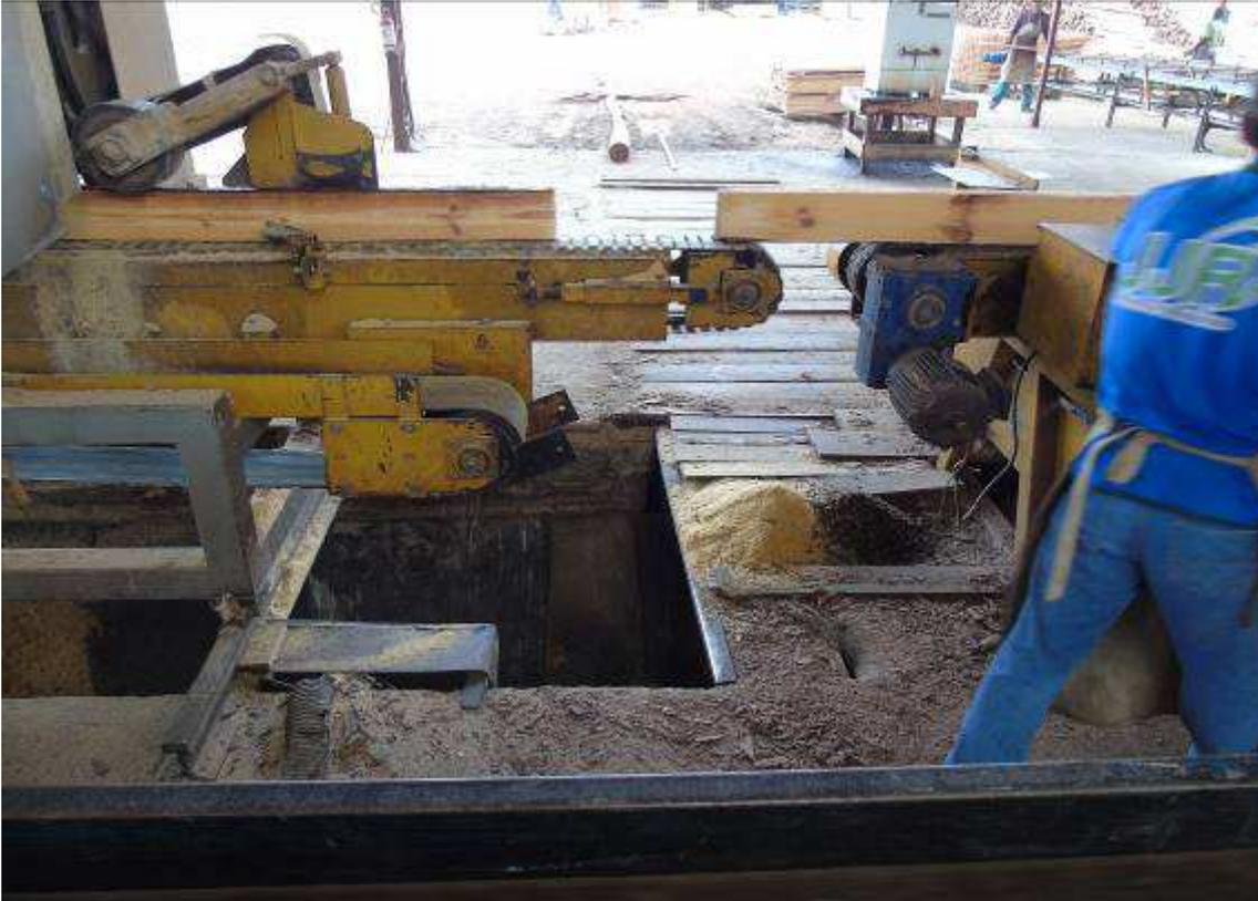
*Figura 66: Abertura no piso que possibilita a queda de pessoas ou objetos sem ser dotada de guarda corpo ou outro tipo de proteção contra quedas.*
