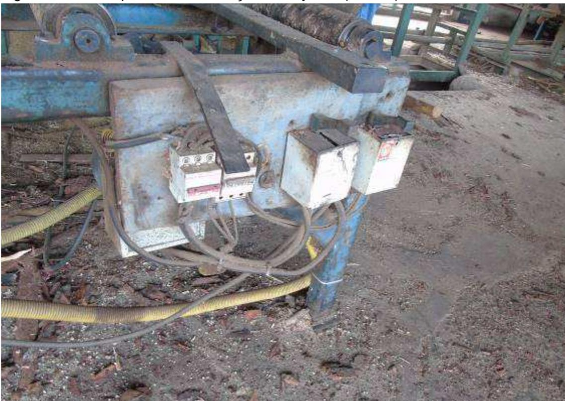
*Figura 6 Instalações elétricas em condições inseguras de funcionamento*
