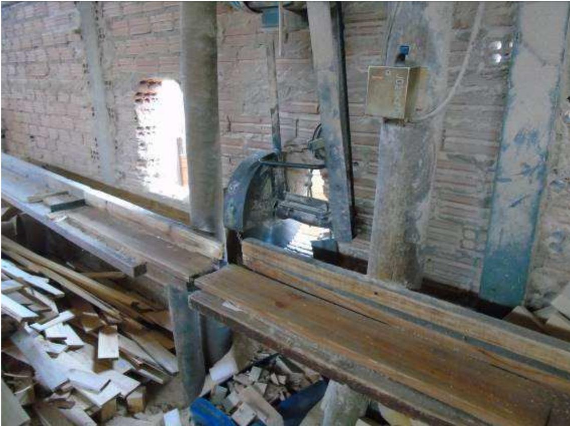
Figura 86: Equipamento sem dispositivos adequados de partida, acionamento e parada. (Chave tipo lombard)
