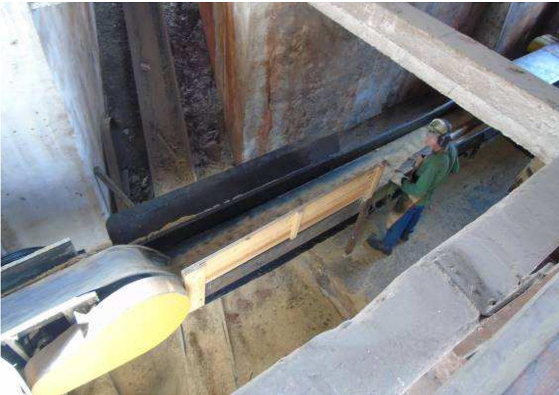
*Figura 18 Transportador contínuo de materiais sem proteção em todas as zonas de perigo*
