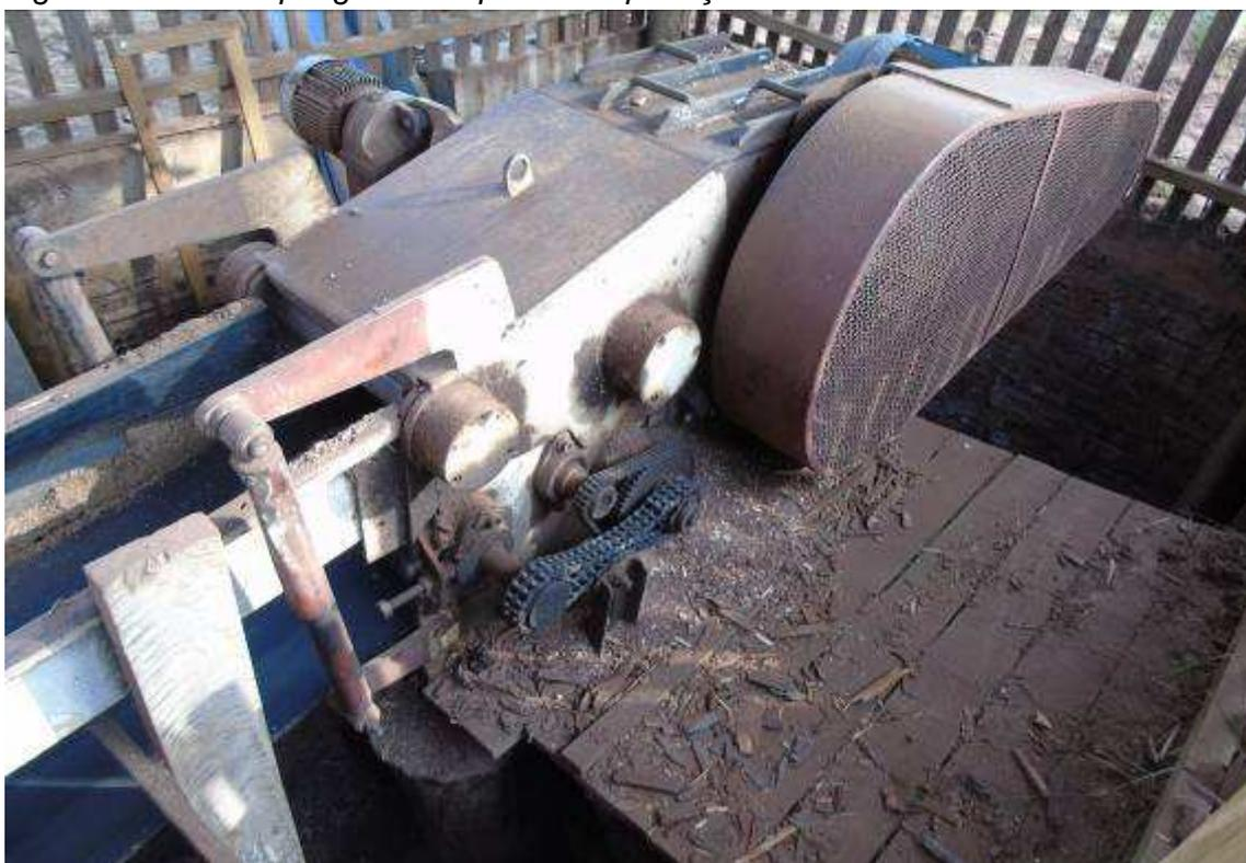
*Figura 34 Zona de perigo de máquina sem proteção*
