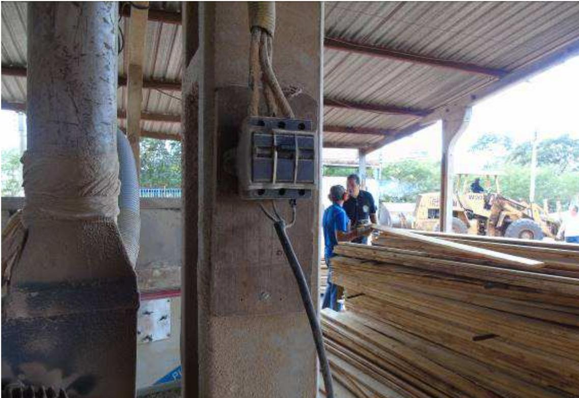
*Figura 15 Dispositivo de acionamento de máquina inadequado*
