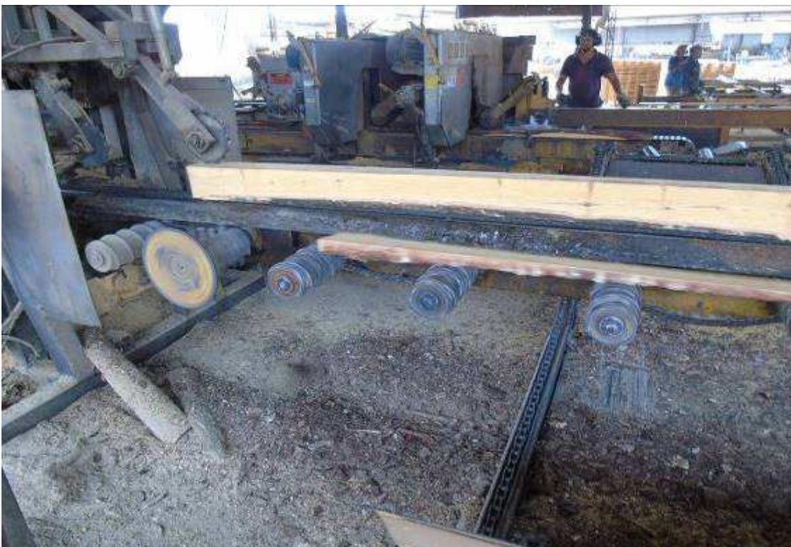
Figura 91: Transportador contínuo de materiais sem proteção dos pontos de esmagamento, agarramento e aprisionamento, como esteiras, roletes, rolo de cauda e outras partes móveis.
