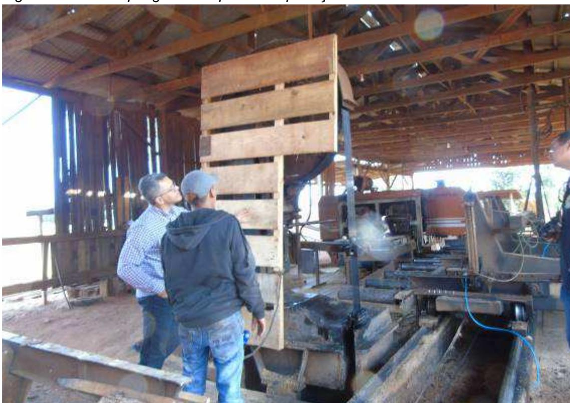
*Figura 32 Zona de perigo de máquina sem proteção*
