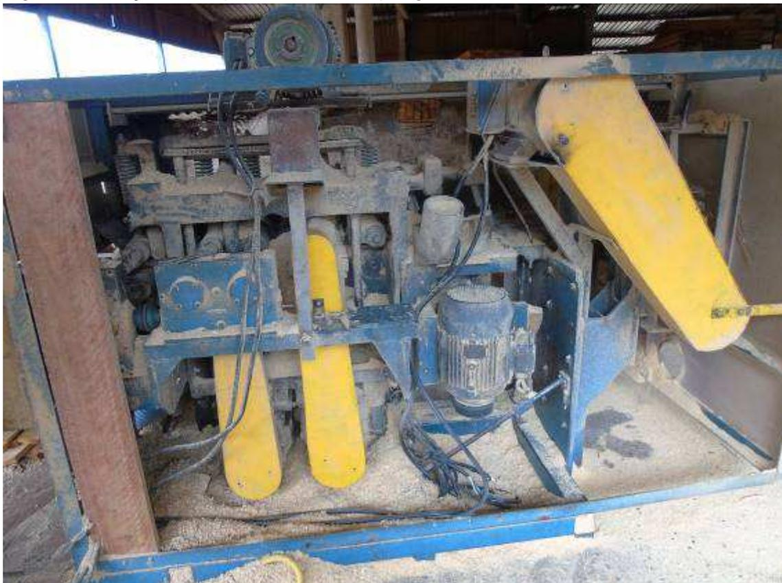
*Figura 8 Zona de perigo de máquina sem proteção*
