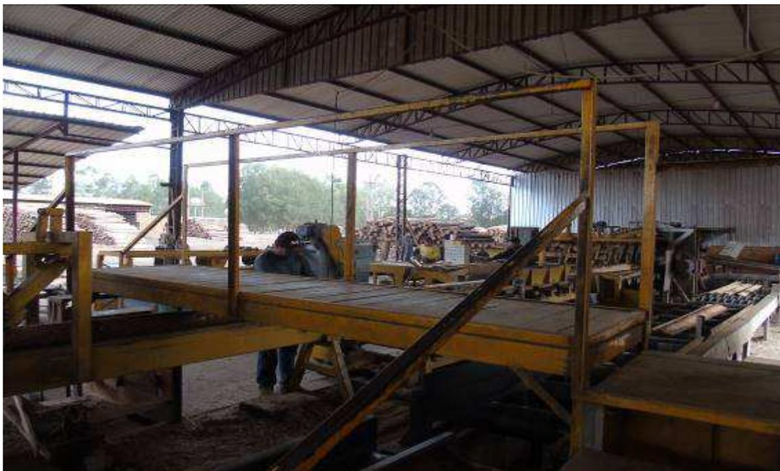
Figura 88: Meio de acesso com risco de quedas, sejam mantidos sem sistema de proteção (guarda corpos com, apenas, travessão superior)
