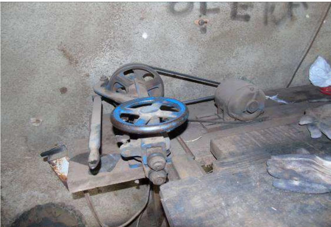
Figura 53: Zonas de perigo de máquina e equipamentos sem possuir sistemas de segurança, caracterizados por proteções fixas, proteções móveis e dispositivos de segurança interligados, que garantam proteção à saúde e à integridade física dos trabalhadores.
