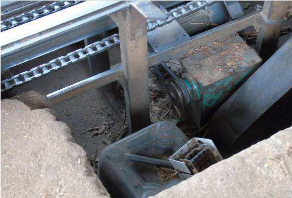
*Figura 44: Abertura no piso que possibilita a queda de pessoas ou objetos sem ser dotada de guarda corpo ou outro tipo de proteção contra quedas.*
