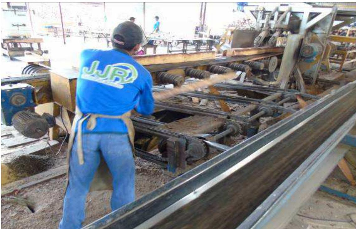
Figura 80: Zonas de perigo de máquina e equipamentos sem possuir sistemas de segurança, caracterizados por proteções fixas, proteções móveis e dispositivos de segurança interligados, que garantam proteção à saúde e à integridade física dos trabalhadores.
