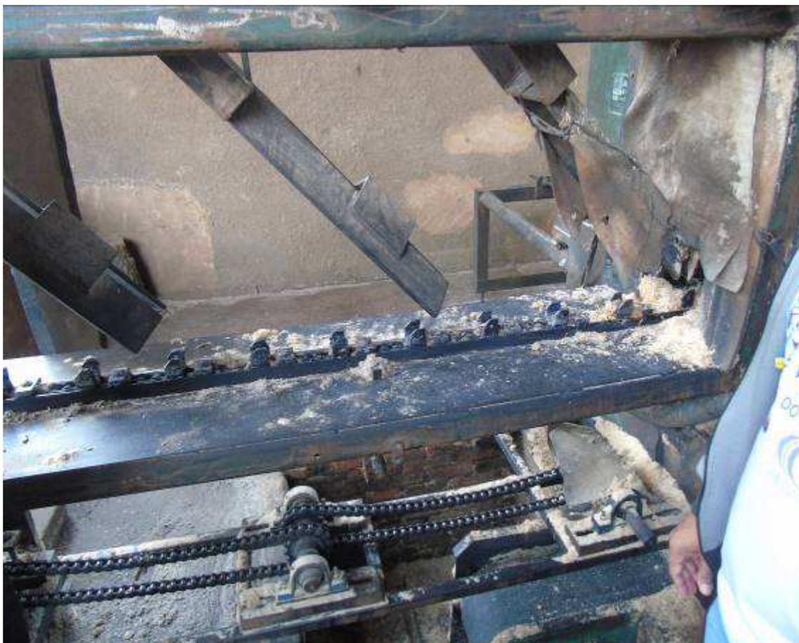
Figura 59: Transportador contínuo de materiais sem proteção dos pontos de esmagamento, agarramento e aprisionamento, como esteiras, roletes, rolo de cauda e outras partes móveis.
