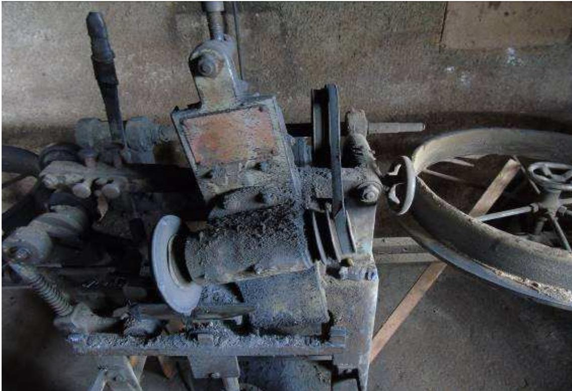
Figura 54: Zonas de perigo de máquina e equipamentos sem possuir sistemas de segurança, caracterizados por proteções fixas, proteções móveis e dispositivos de segurança interligados, que garantam proteção à saúde e à integridade física dos trabalhadores.
