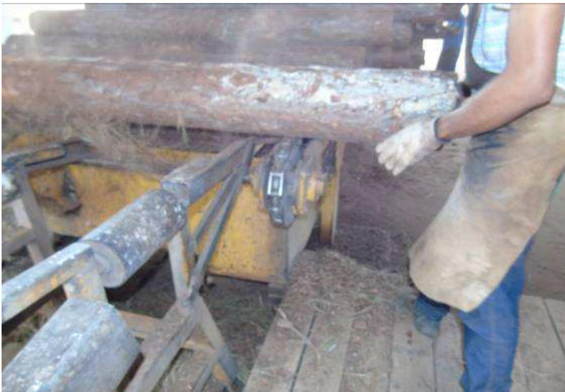
Figura 90: Transportador contínuo de materiais sem proteção dos pontos de esmagamento, agarramento e aprisionamento, como esteiras, roletes, rolo de cauda e outras partes móveis.
