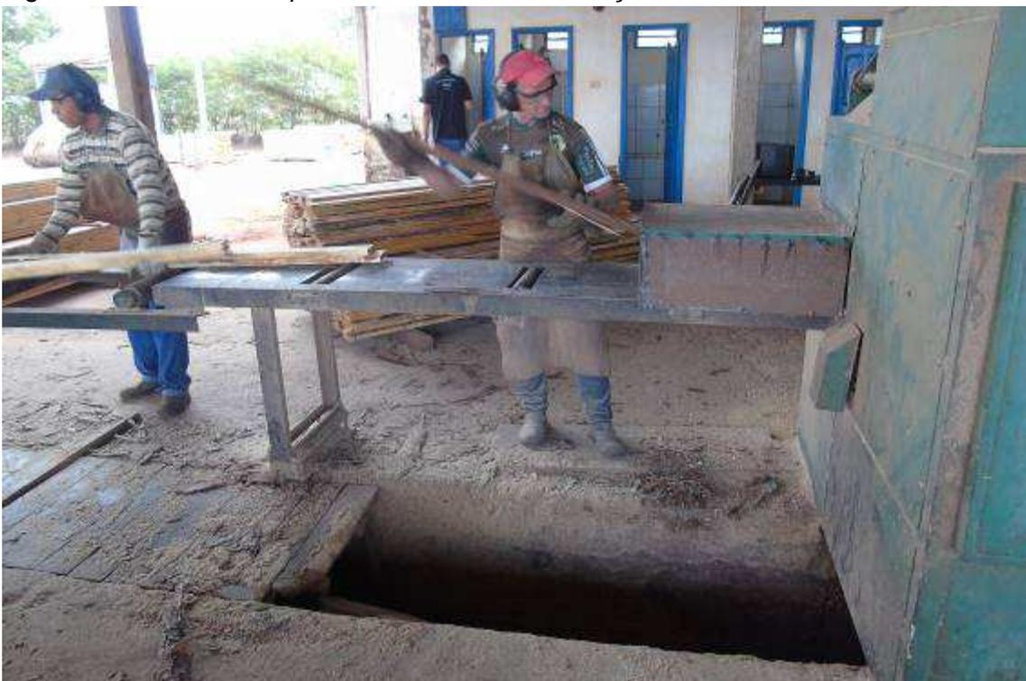
*Figura 4 Abertura no piso sem proteção*
