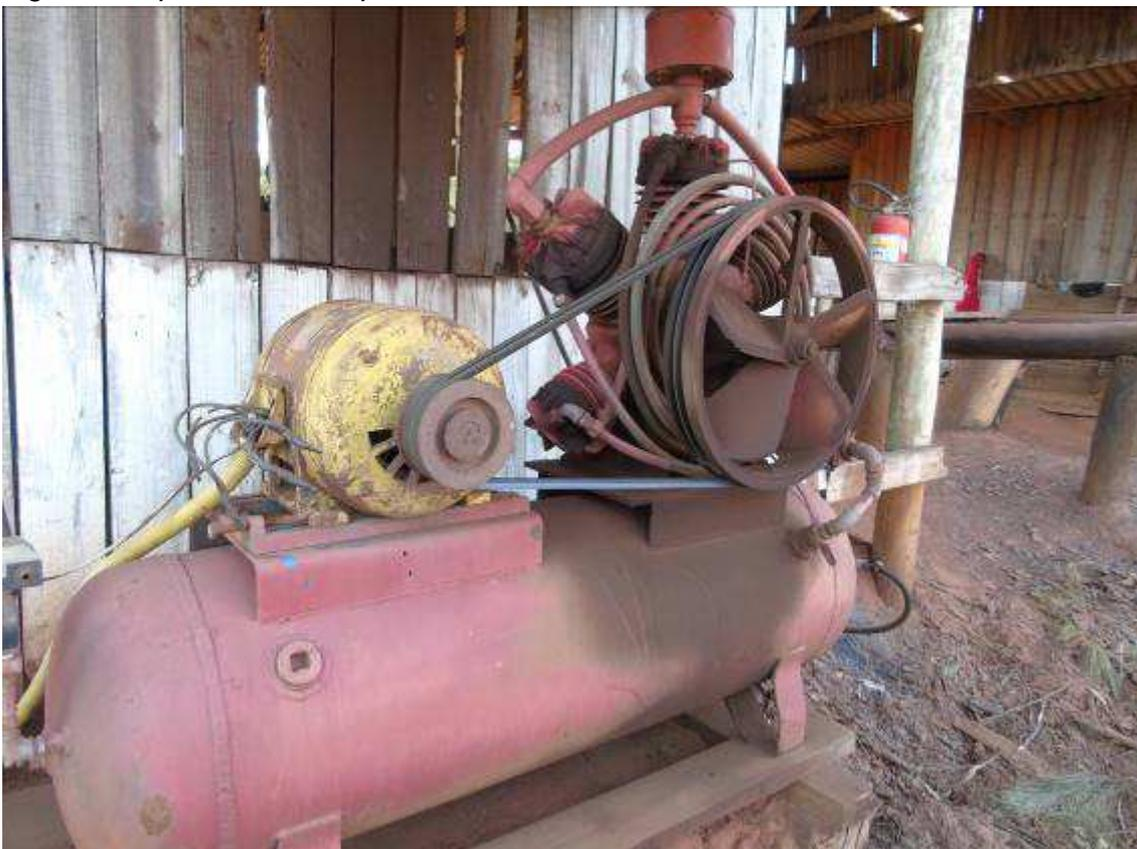
Figura 30 Zona de perigo de máquina sem proteção
