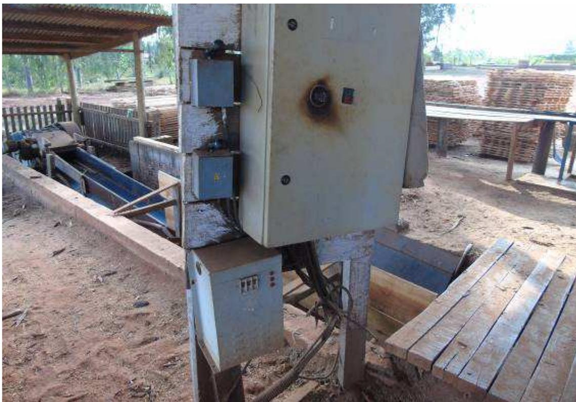
*Figura 37 Dispositivo de acionamento de máquina inadequado*
