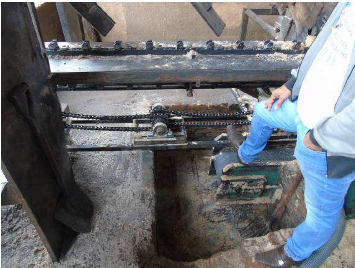
*Figura 43: Abertura no piso que possibilita a queda de pessoas ou objetos sem ser dotada de guarda corpo ou outro tipo de proteção contra quedas.*
