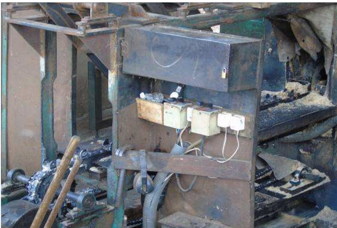
Figura 57: Equipamento sem dispositivos adequados de partida, acionamento e parada. (Chave tipo lombard)
