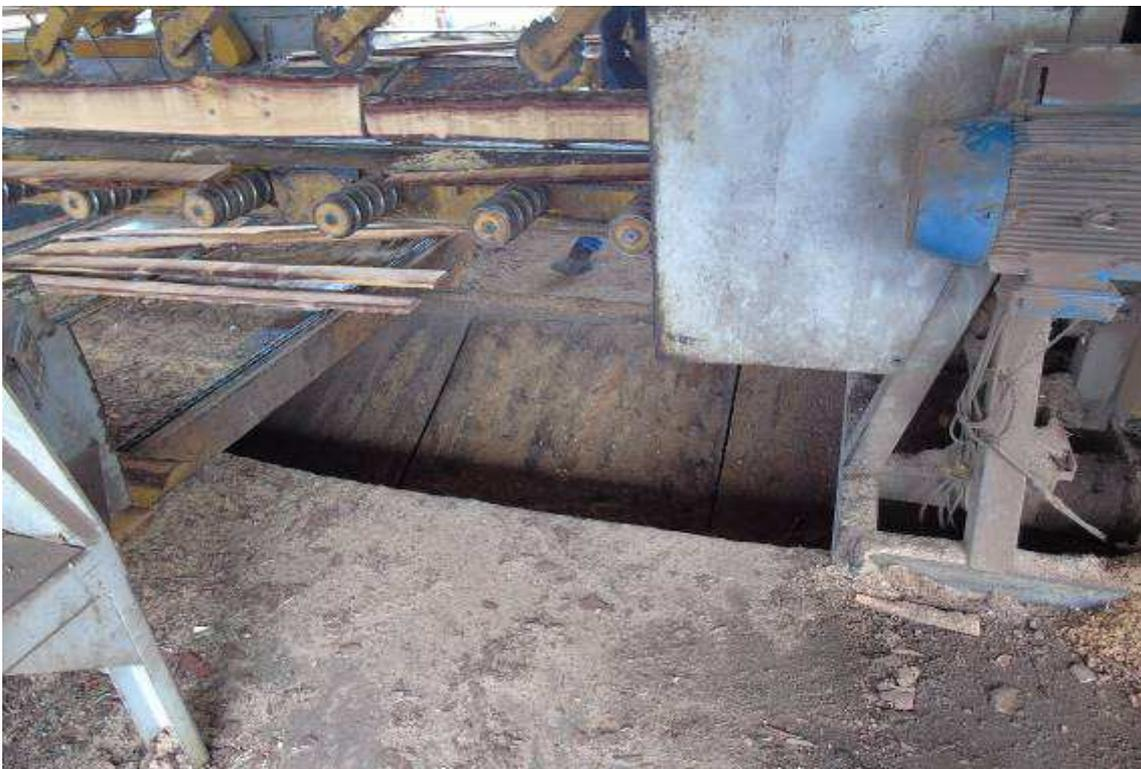
Figura 65: : Abertura no piso que possibilita a queda de pessoas ou objetos sem ser dotada de guarda corpo ou outro tipo de proteção contra quedas.
