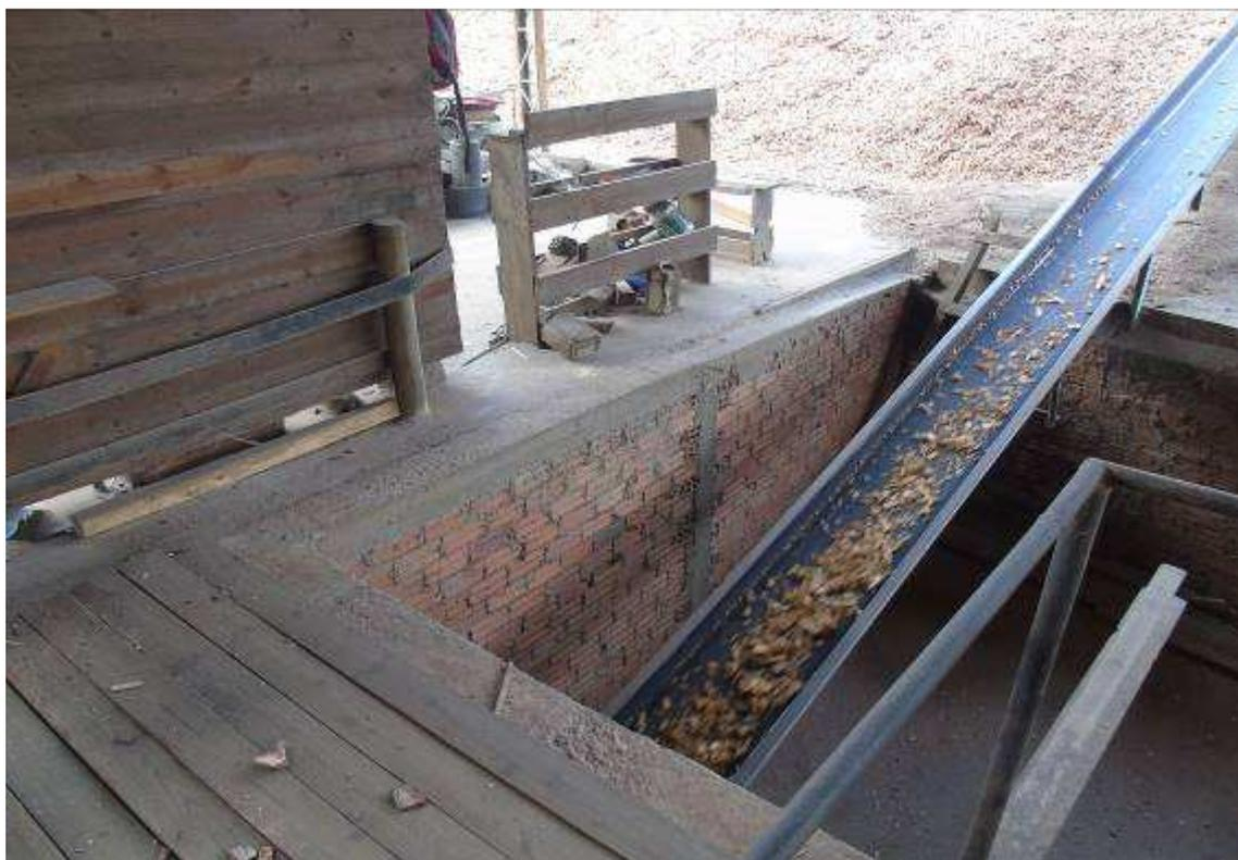
Figura 73: Local de trabalho, acima do solo, sem ser dotado de proteção contra quedas (guarda corpo de proteção)
