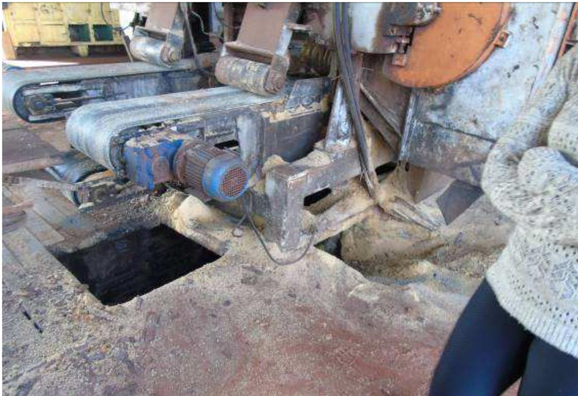
*Figura 25 Abertura em piso sem proteção contra quedas*
