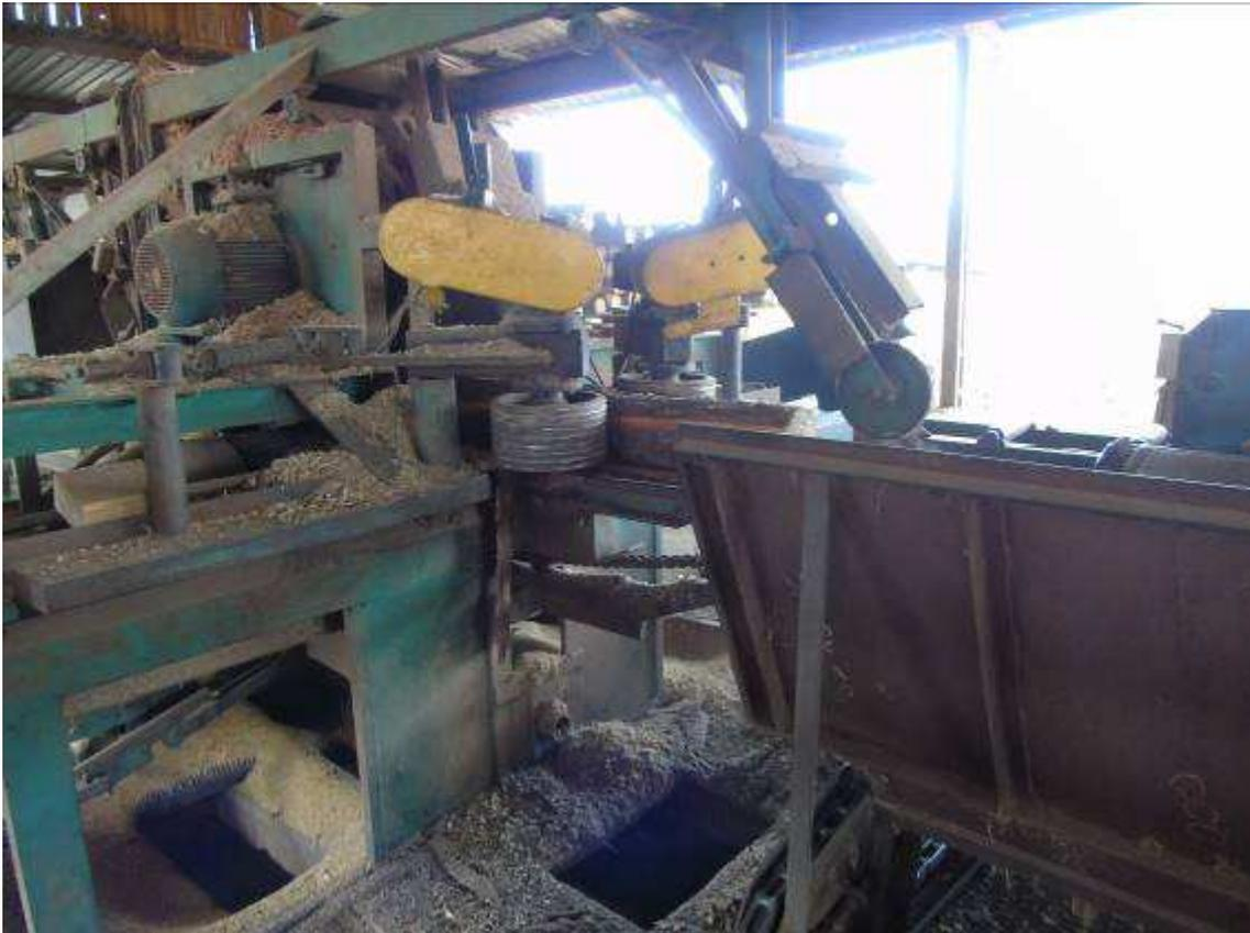
*Figura 9 Zona de perigo de máquina sem proteção*
