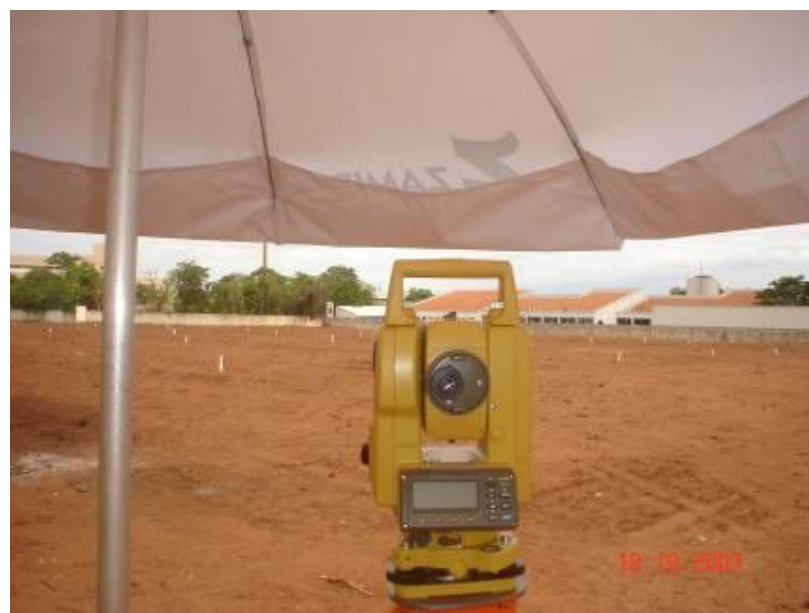
Levantamento Planialtimétrico – conferência dos níveis do projeto.
