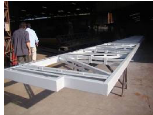
Detalhe das peças prontas no pátio da indústria e da montagem da viga treliçada do plenário principal
