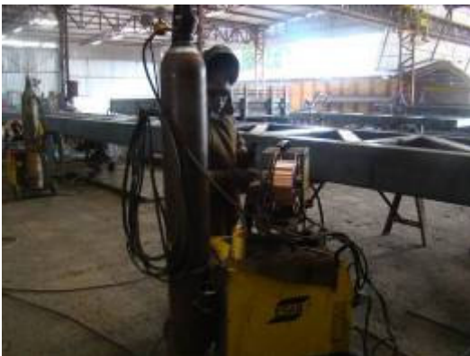
Detalhe das peças prontas no pátio da indústria e da montagem da viga treliçada do plenário principal
