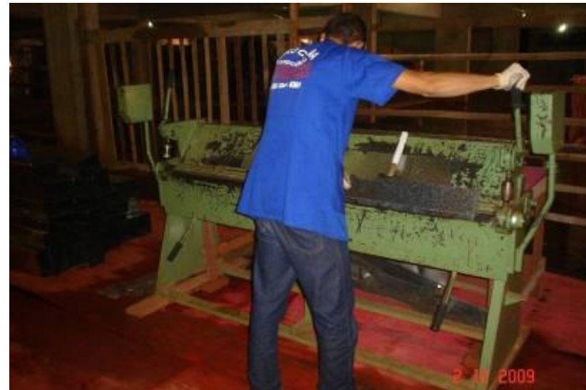
Detalhe da prensa para dobra de chapas de aço galvanizado para dutos de exaustão/insuflamento do sistema de climatização
