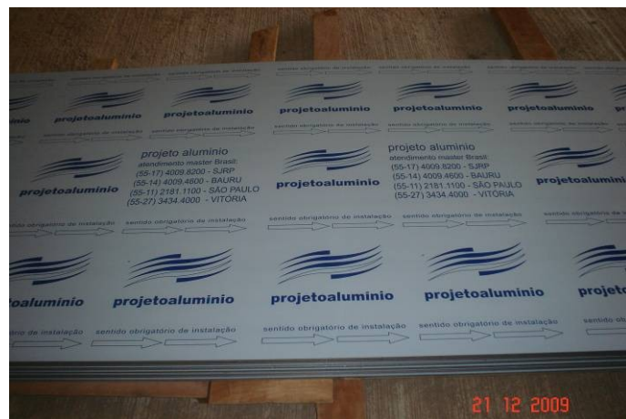
Detalhe da placa do revestimento em alumínio composto.
