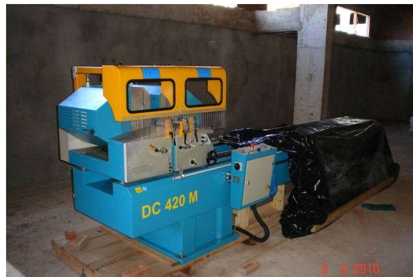
Detalhe da máquina para corte e dobra de revestimento em alumínio composto.
