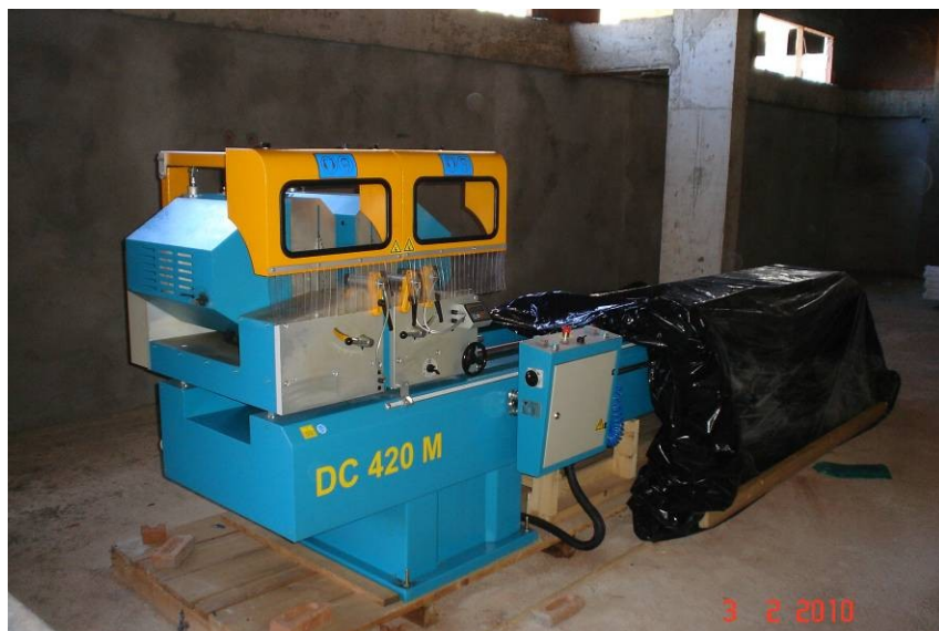
Detalhe do equipamento para corte de chapas de alumínio composto.
