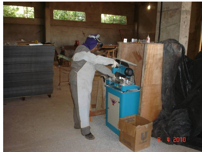
Detalhe do equipamento de corte para perfis de alumínio das esquadrias.
