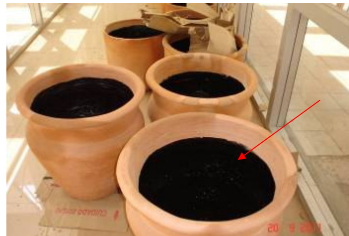
Detalhe da pintura para impermeabilização do vaso cerâmico para paisagismo.
