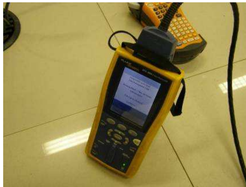
Detalhe do equipamento de certificação digital do cabeamento estruturado (Fluke)
