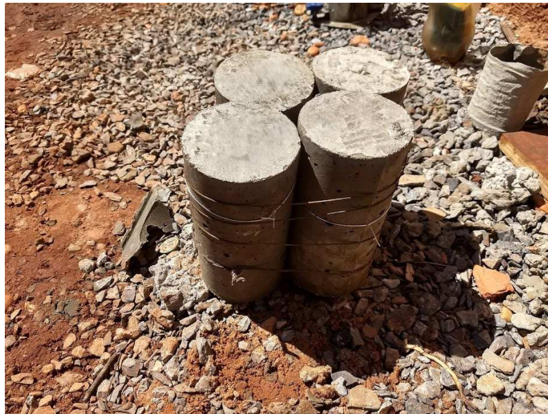
CONTROLE TECNOLÓGICO E CONCRETAGEM DO RADIER DO ABRIGO DE LIXO
