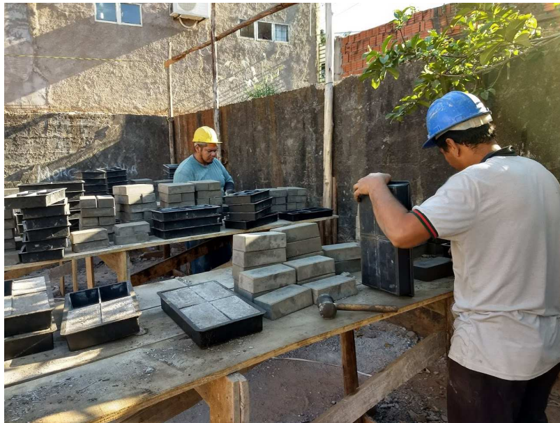
Detalhe da fabricação dos ecoblocos no canteiro de obra
