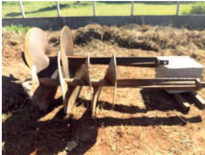
Detalhes das brocas, base de concreto e estaca escavada das fundações
