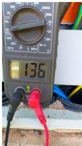
Medida realizada no disjuntor defeituoso (Tensão Fase-Fase): A tensão entre fases estava abaixo do padrão (136 V)
